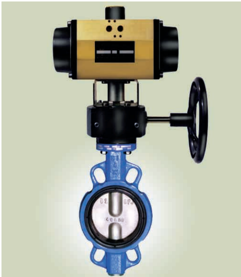
VALVOLA A FARFALLA con attuatore pneumatico mod. AP a doppio o semplice effetto con comando manuale d'emergenza mediante riduttore ad ingranaggi disinnestabile. BUTTERFLY VALVE with double or spring return pneumatic actuator mod. AP featuring emergency manual control through disengageable reduction gear.
